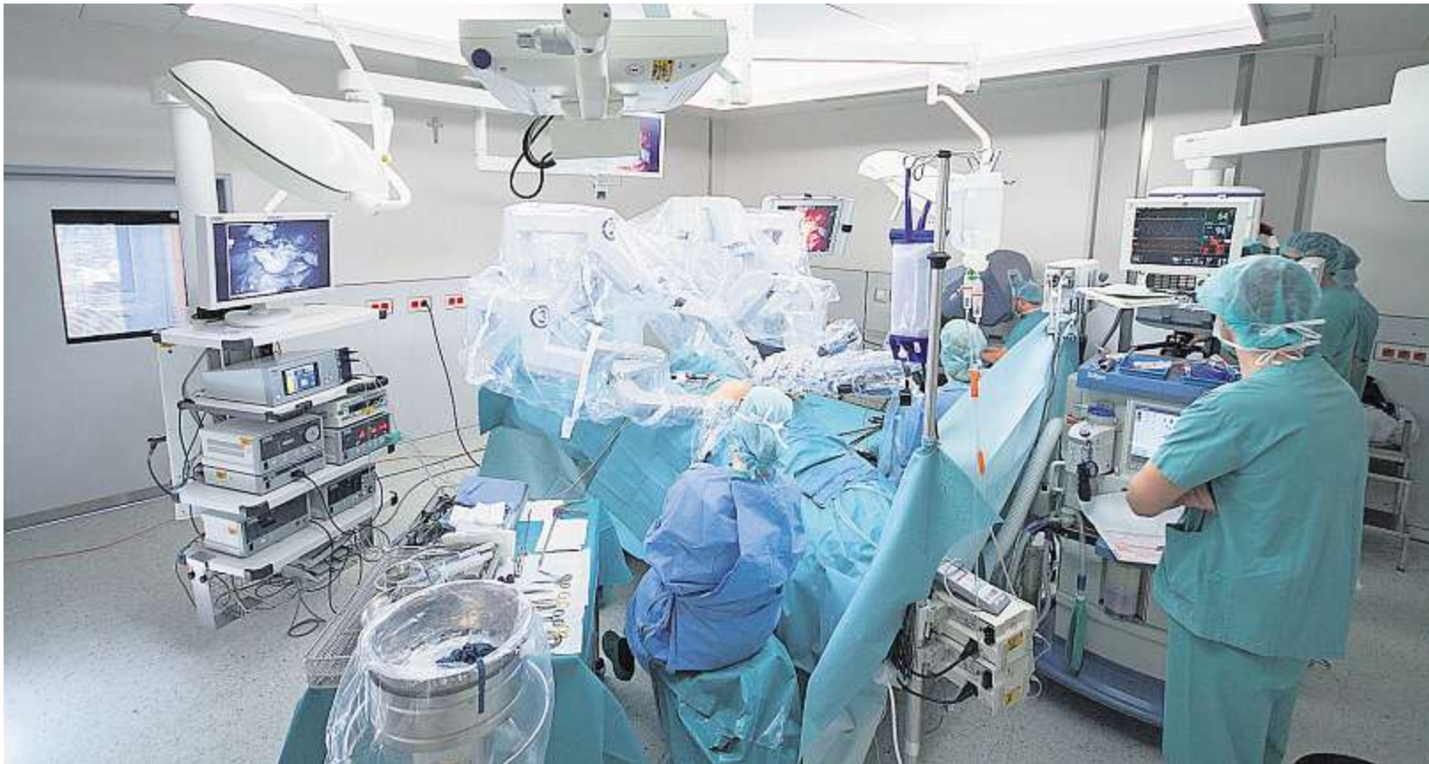
Das „da Vinci“-System verfügt über vier Roboterarme, die während der Operation in sterile Plastikfolie eingepackt sind.
